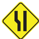
A-21d Alargamento de pista à esquerda
