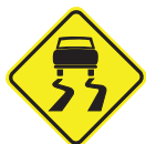
A-28 Pista escorregadia
