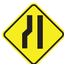
A-21b Estreitamento de pista à esquerda
