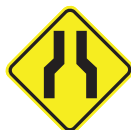
A-21a Estreitamento de pista ao centro
